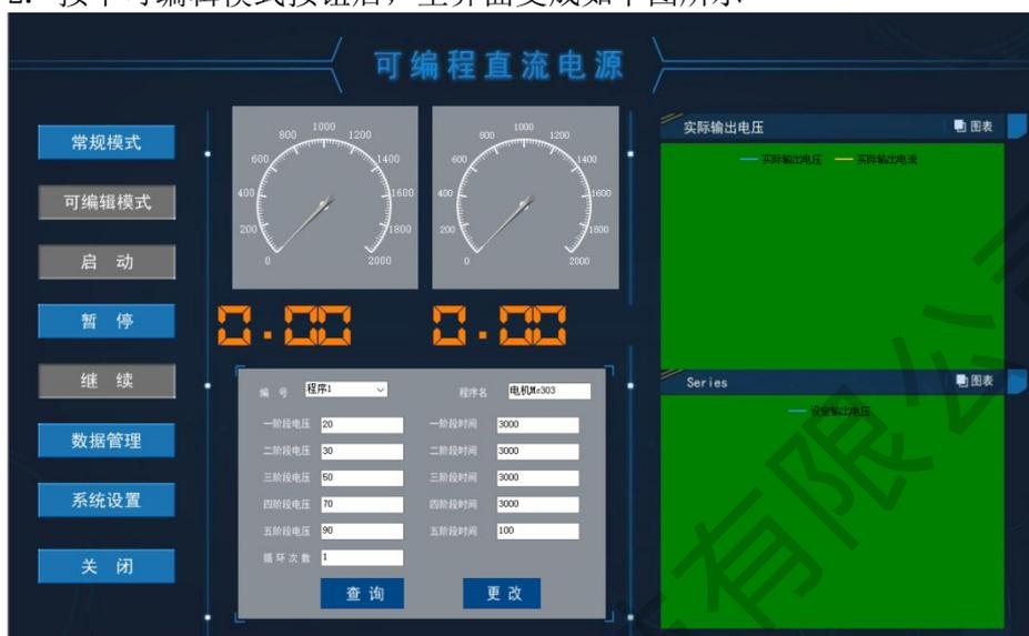
3. 电压/电流设置区中的编号下拉框中，可以选择你执行的可编辑程序编号。
