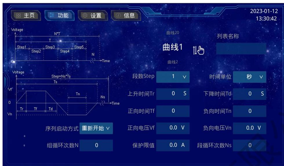
可以通过编辑序列操作每一个单步的值及时间来产生各种输出变化顺序。序列操作中的参数包括段数Step、时间单位、上升时间Tr、下降时间Td，正向时间Tf、负向时间Tn、正向电压Vf、负向电压Vn、保护限值、段循环次数Ns、组循环次数N、序列启动方式。
